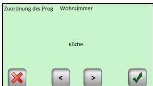
Mit den Tasten (<) und (>) Programm einer anderen Zone wählen und dann die Bestätigungstaste betätigen: das Programm bekommt automatisch denselben Namen wie die aktuelle Zone. Das auf diese Weise gebildete Programm kann dann geändert werden, ohne dass es zu Änderungen bei dem vorigen Programm kommt.
