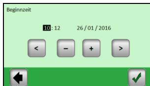
Gewählten Parameter (schwarz unterlegt) mit den Tasten (+) oder (-) einstellen; mit den Tasten (</>) an Rändern des Bildschirms den Cursor zum nächsten Parameter verschieben und bestätigen, wenn er in Ordnung ist.
