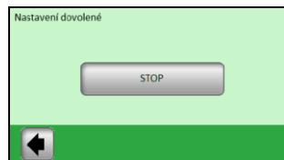
Nastavte zvolený parametr (inverzně podsvícený) pomocí tlačítka (+) nebo (-); pomocí tlačítka (<)(>) na okrajích obrazovky posuňte kurzor na další parametr a potvrďte jej, když je v pořádku.
