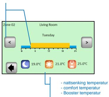
**"Modify"** - ved å trykke på "modus" knappen, vil du ha mulighet til å endre programmet dag for dag med 15 minutter trinn og med mulighet til å velge mellom tre temperaturverdier.
