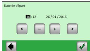
Réglez le paramètre sélectionné (surligné en noir) en utilisant les touches (+) ou (-); déplacez le curseur au paramètre suivant avec les touches (<) et (>) de part et d'autre de l'écran puis validez lorsque les réglages sont faits.
