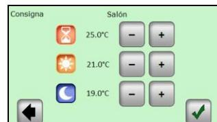
Ajuste los valores de temperatura requeridos con la ayuda de los botones (+) o (-). Confirme o cancele el cambio pulsando el botón correspondiente en la parte inferior de la pantalla.
