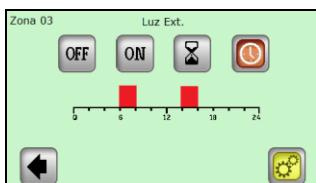
Para cambiar el modo de trabajo, pulse directamente sobre el ícono del modo deseado.
