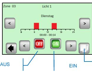
Die Bedienung auf dem Empfänger V25 ermöglicht ihn direkt einzustellen (EIN/AUS, Timer 2 Stunden) und ist den Anweisungen der Zentraleinheit übergeordnet.
