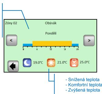
**„Upravit“** – stisknutím tlačítka „Upravit“ budete mít možnost změnit program den po dni s 15minutovými kroky a budete mít možnost volby mezi třemi hodnotami teploty.
