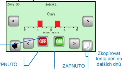
Ovládání na přijímači V25 umožňuje jeho přímé nastavení (Vypnuto/Zapnuto, Časovač 2 hodiny) a je nadřazeno pokynům centrální jednotky.
