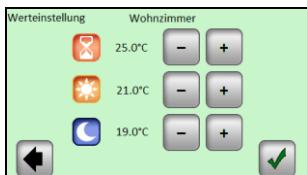
Mit den Tasten (+) oder (-) die gewünschten Temperaturwerte wählen. Die Änderung mit Betätigung jeweiliger Taste im unteren Teil des Displays bestätigen oder löschen.
