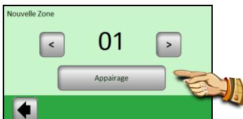
L'unité de contrôle est en attente d'un récepteur en mode "RF INIT".
