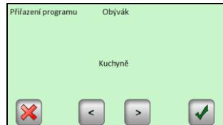
Pomocí (<) a (>) zvolte program jiné zóny a pak stiskněte tlačítko potvrzení: program se automaticky přejmenuje na stejný název, jaký má aktuální zóna. Program vytvořený tímto způsobem může být následně pozměněn bezem změny předchozího programu.
