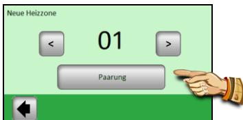
Die Steuereinheit wartet auf den Empfänger im Modus „RF ini“.
