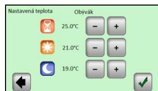
Nastavte požadované hodnoty teploty pomocí tlačítka (+) nebo (-). Změnu potvrďte nebo zrušte stisknutím příslušného tlačítka ve spodní části displeje.
