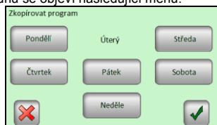
Referenční den v příkladu je „Úterý“, zvolené dny jsou zvýrazněné modrým rámečkem. Klikněte na tlačítko Potvrzení, aby se program zkopioval do všech zvolených dnů, ve kterých si přejete program mít.
