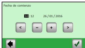
Ajuste el parámetro seleccionado (retro-iluminado) usando los botones (+) o (-); mueva el cursor al siguiente parámetro usando los botones de los bordes de la pantalla (<) (>) y valide cuando esté OK
