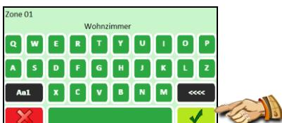
Die Taste „Aa1“ wird für Umschalten zwischen den verschiedenen Tastaturen verwendet (Groß- und Kleinschreibung, Zahlen und spezielle Zeichen). Mit der Taste „<<<“ werden Zeichen gelöscht. Ist der Name richtig, die Taste Bestätigung betätigen.
